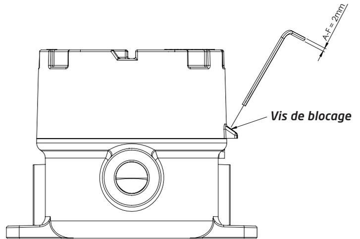
1. Desserrer la **vis de blocage**, à l'aide d'une clé BTR six pans de 2 [mm]. Cette vis est située sur la partie basse du couvercle.
