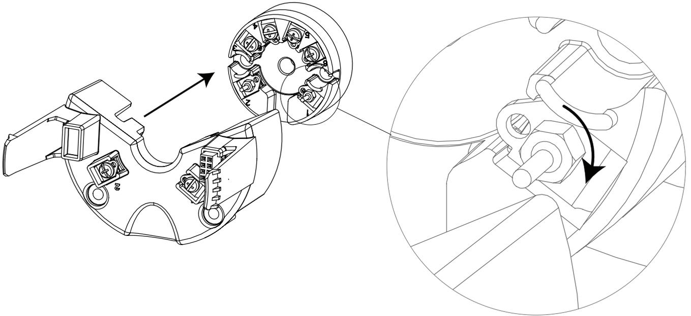
1. Sur le 5335 / 5337, retirer les vis des bornes 1 and 2 avec l'aide d'un tournevis.
