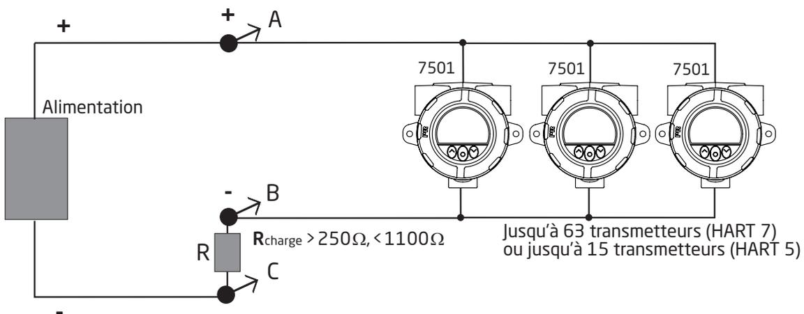
La pockette HART ou le modem HART peuvent être raccordés entre AB ou BC.
